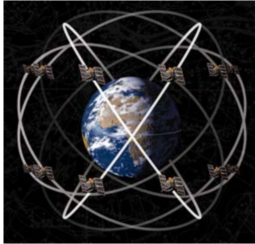
圖 4-1 衛星定位系統示意圖（GPS 共有 24 顆衛星均勻分布於 6 軌道面上）
