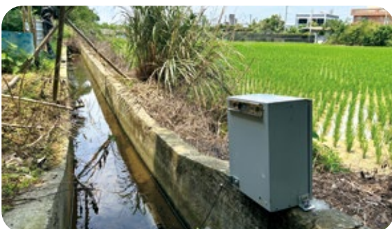
● 本署與環境部監測資訊司裝設連續智慧水質感測器
