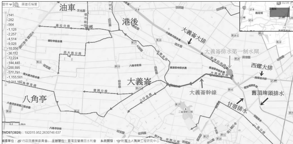
圖 12-15 大義崙幹線灌溉系統圖
