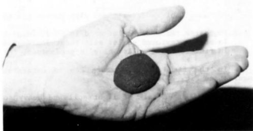
圖 2-5 細質地土壤擠壓成一球形
