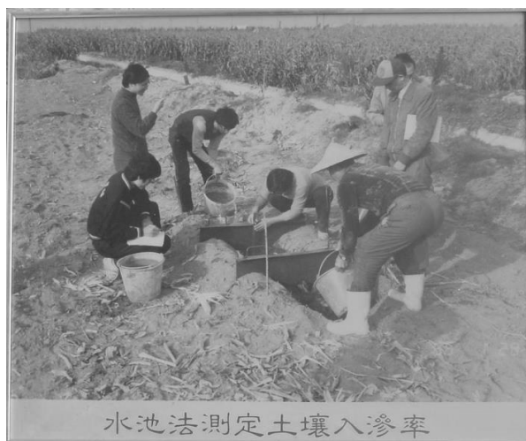
圖 8-36 水池法田間土壤入滲率測定情形
