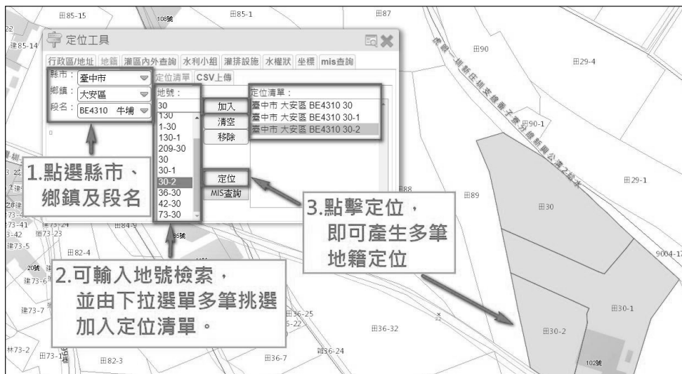
圖 5-10 地籍定位之多筆定位方式
