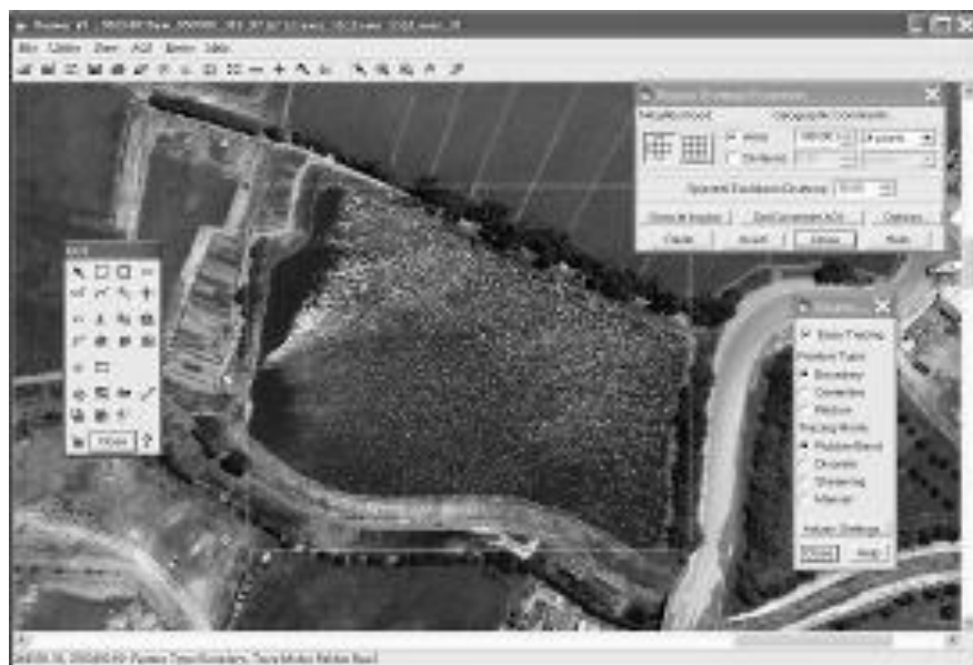
圖 5-63 以 ERDAS Image AOI 工具列顯示水波光影之埤塘水面
