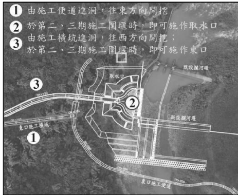
圖 7-12 東洞口銜接構造物及洞口段 施工順序
