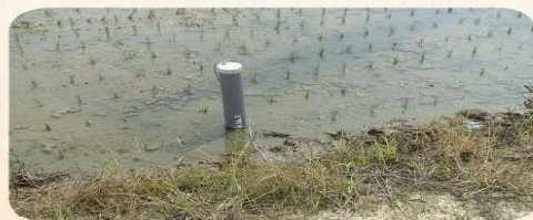
感知器監控田間水位、土壤含水量、即時雨量。
