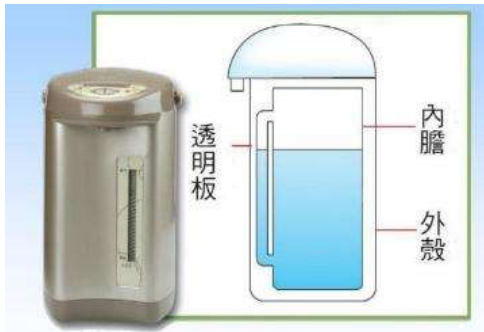
照片 9 連通管應用在判讀熱水壺內的水位
