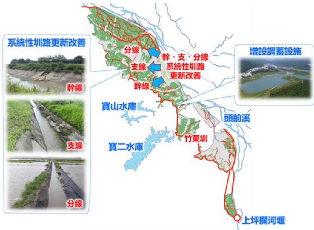
圖 5：系統性灌溉圳路更新改善（含調蓄設施）示意圖
